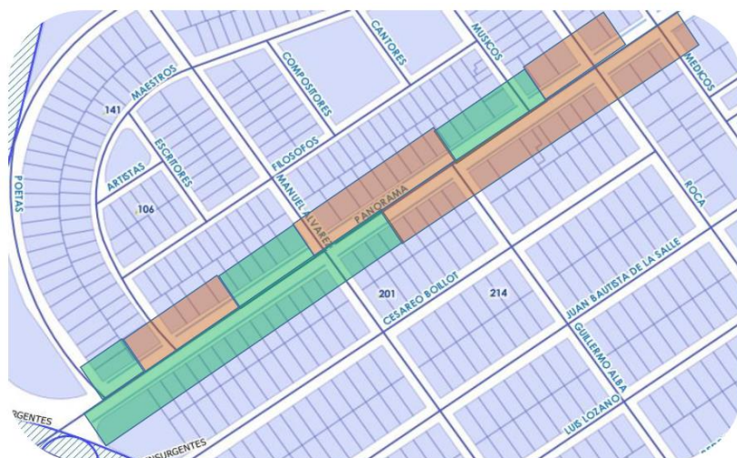
Figura 3: Representación de del cumplimiento de las dimensiones en banqueta con respecto a la norma establecida.
