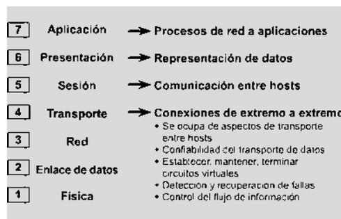
Figura 6., las siete capas del modelo OSI, y detalla las funciones de la capa 4. Fuente Cisco (2003)
