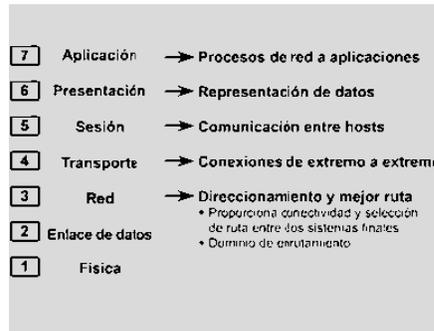
Figura 5. las siete capas del modelo OSI, y detalla, las funciones de la capa 3. fuente : Cisco (2003)
