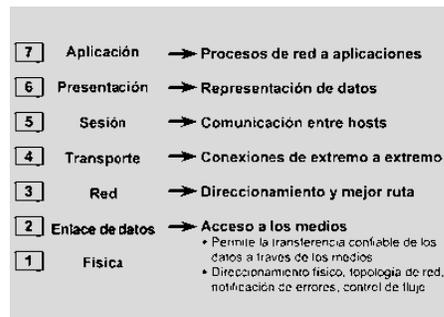
Figura 4. las siete capas del modelo OSI, y detalla, las funciones de la capa 2. fuente : Cisco (2003)
