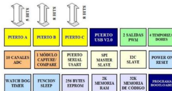
Figura 2: Diagrama de bloques del Microcontrolador Pic18f2550.
