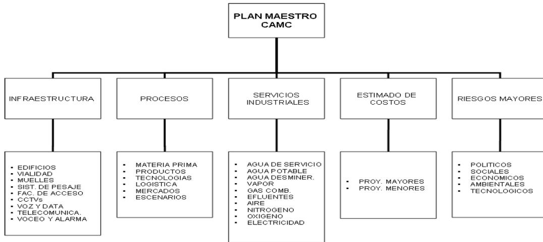
Figura 2. Estructura Desagregada de Trabajo (EDT)
