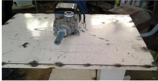
*Figura 5.* Colocación y anclaje de bomba centrífuga a la lámina superior
