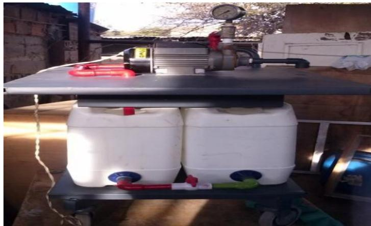
Figura 9. Ensamblaje y aplicación de pintura al banco de prueba portátil
