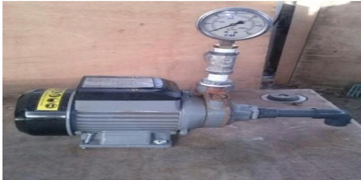
Figura 8. Instalación del manómetro en la bomba centrífuga
