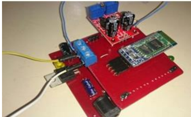
Figura 5. Circuito del cerebro. Módulo Arduino Bluetooth Fuente: Elaboración Propia (2017)
