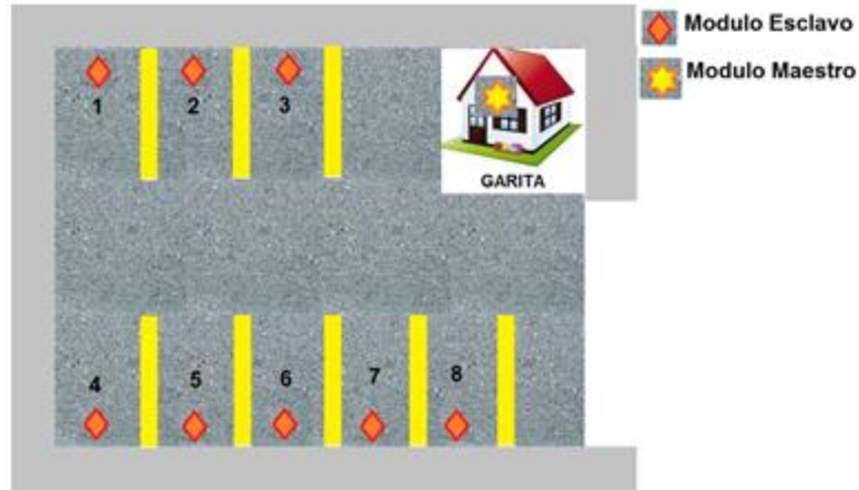
Figura 10. Ilustración de una red de sensores desplegada en un parqueadero Fuente: Propia (2017)
