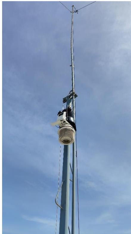
Estación Meteorológica Profesional Davis Instruments 6262EU Vantage Pro 2 Plus. Se trata de la nueva versión inalámbrica de las estaciones Vantage Pro 2 Plus, combinada con la consola conectada a la pantalla táctil Weatherlink. Modelo con sondas solares para medir Radiación Solar y sonda Ultra Violeta)
