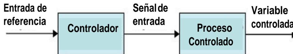
**Fig. 6 Elementos de sistema de control a lazo abierto**
