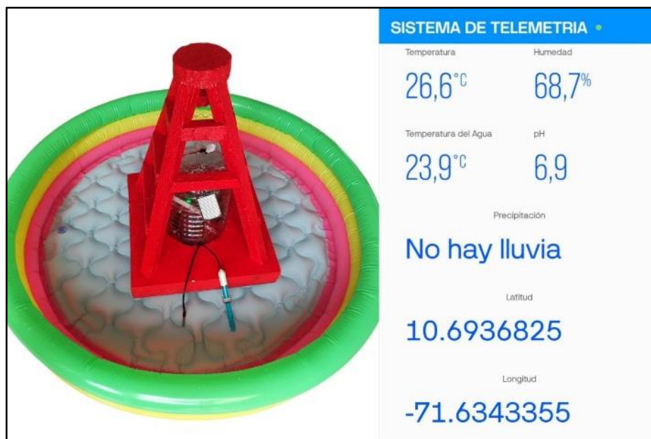
Figura 4. Sistema de telemetría en boya marina para el monitoreo de variables meteorológicas en el Lago de Maracaibo Fuente: Hnidi y Romero (2024)
