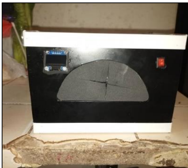
Figura 2: Switch de encendido y apagado y pantalla OLED del sistema. Fuente: Barrios, Boscán y Prieto (2024).
