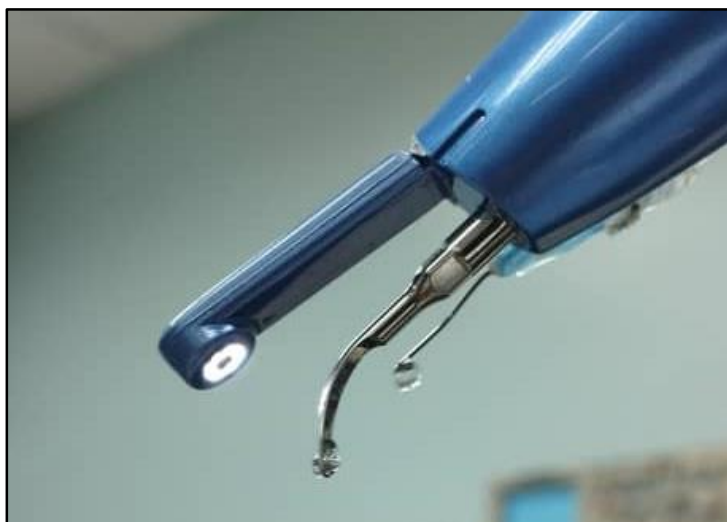
Figura 10. Cavitron, la salida de agua o aire y la cámara intraoral. Fuente: Angel, García y Villasmil (2024)
