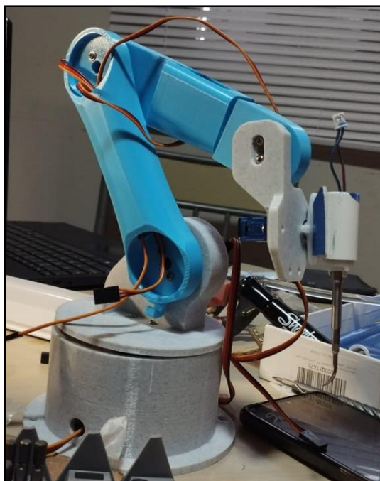
Figura 9. Ensamblaje del Brazo Robótico. Fuente: Ángel, García y Villasmil (2024)
