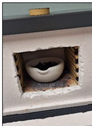
(a) Mezcla de \text{NaCO}_3 y \text{MnO}_2 , (b) \text{NaMn}_2\text{O}_4 resultante Fuente: González, Leal y Rodríguez. (2024)
