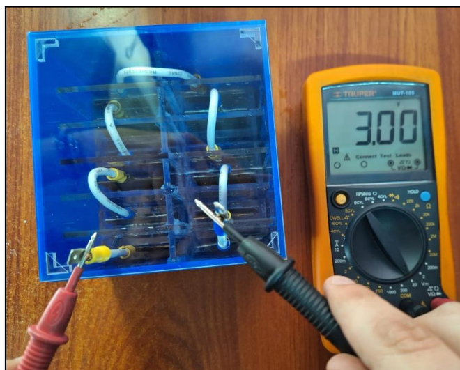
Medición con multímetro del prototipo de la batería de sodio.
