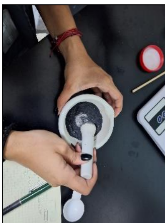
(a) Mezcla de \text{NaCO}_3 y \text{MnO}_2 , (b) \text{NaMn}_2\text{O}_4 resultante Fuente: González, Leal y Rodríguez. (2024)
