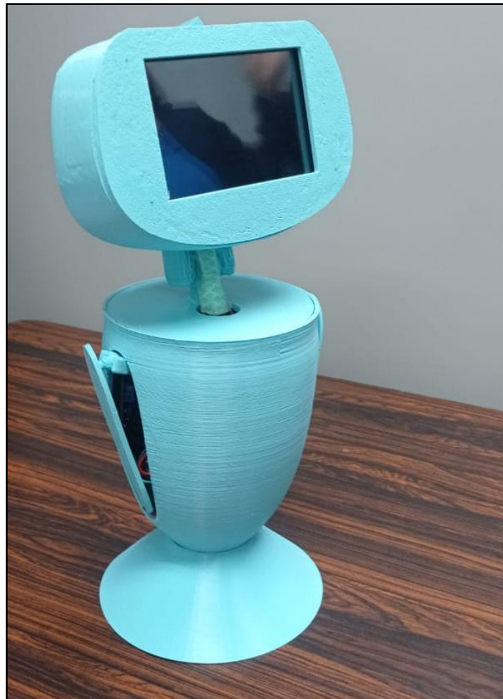
Figura 4. Armazón del Prototipo Fuente: Crespo, Díaz y Rincón (2024)
